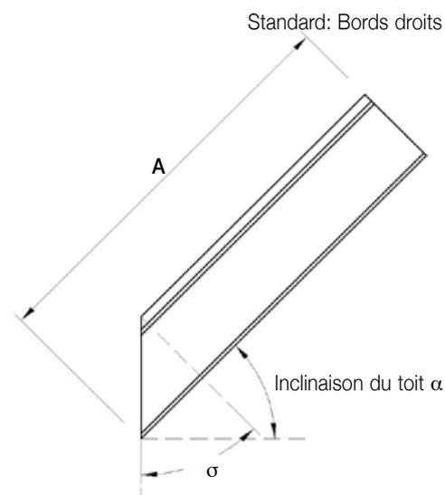
Coupe de gouttière négative  $\sigma =$  inclinaison du toit  $\alpha$
